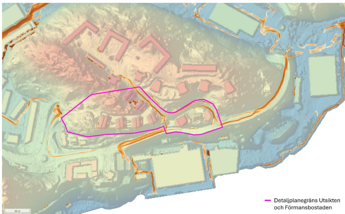
Figur 20. Beräknade maximala vattenflöden (Flux) vid ett modellerat 100-årsregn med klimatfaktor. Planerad situation, scenario 1.
