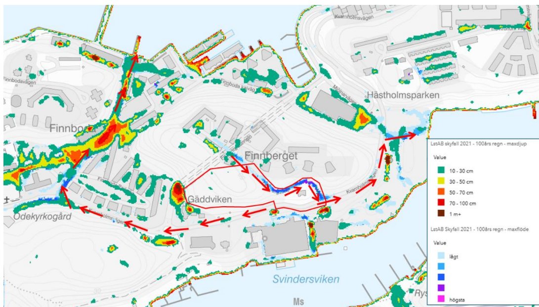
Figur 4. Beräknade maximala vattendjup. Skyfallsanalys Länsstyrelsen. Kartunderlag för klimatanpassning . Detaljplaneområdet Utblicken och Förmansbostaden markerat i rött. Pilar indikerar de två större avrinningsvägarna.
